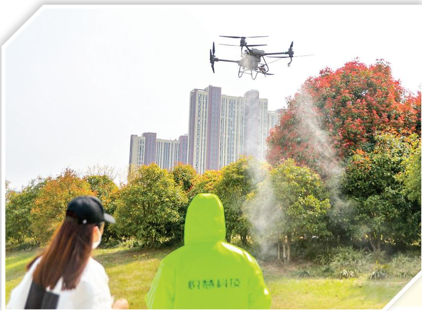
4月6日下午,伴随着轰鸣声,一架无人机自京杭大运河畔的运南东路起飞,对沿岸绿化苗木进行药物喷洒作业。这是市园林绿化管理中心首次引入新型高空无人机开展药物喷洒。与传统人工喷洒药物相比,无人机的喷洒区域更广,尤其适用于树木密集区域的高空作业。以往需要大半天才能完成的工作量,现在只需短短几分钟,喷洒效率大为提高,农药分布也更加均匀。
