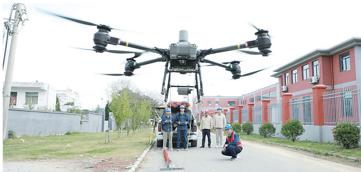
无人机手控制运载无人机搭载特制间隔棒起飞
