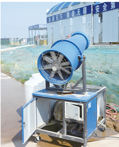
连日来,清江浦区黄码港在推进提升工程项目建设提速增效的同时,常态化开展大气扬尘管控工作。图为新能源洒水雾炮一体机和可移动雾炮正在作业。
