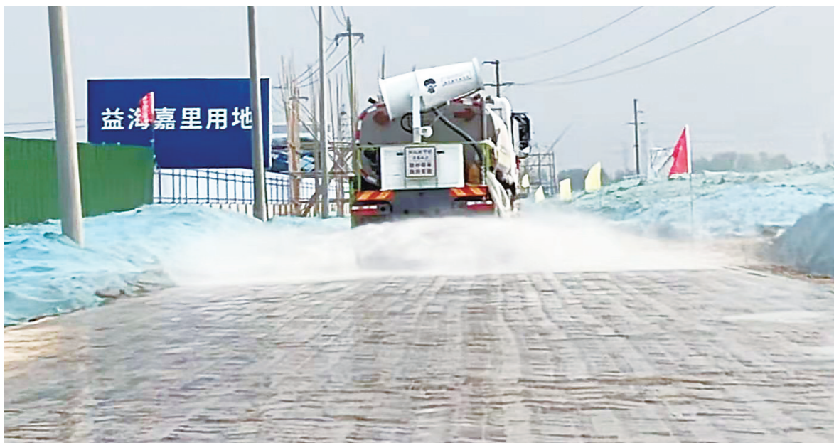
连日来,清江浦区黄码港在推进提升工程项目建设提速增效的同时,常态化开展大气扬尘管控工作。图为新能源洒水雾炮一体机和可移动雾炮正在作业。
